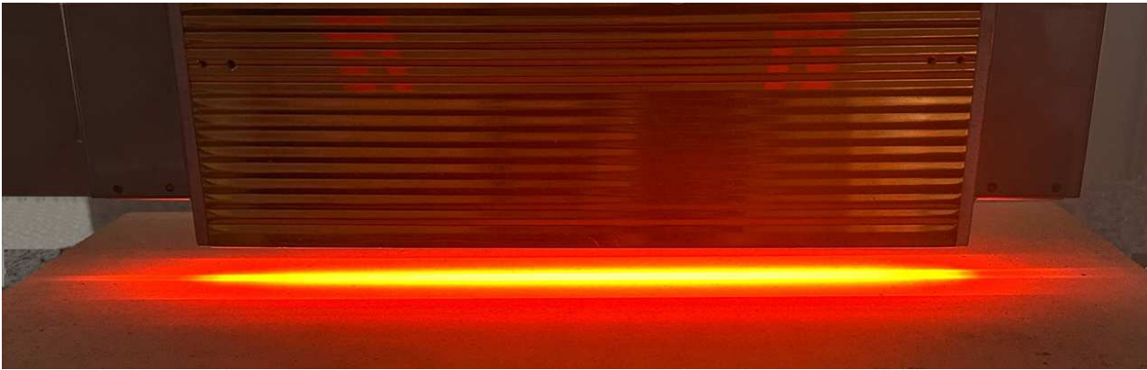
อิฐทนไฟได้รับการฉายรังสีด้วย HLH-55W/f25/L280 จากระยะที่กำหนด 25 mm
