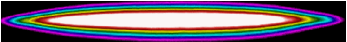
เป็นแผนภาพภาพความร้อนเมื่อฮีททงความร้อนถูกฉายรังสีที่ระยะ 75 มม.
